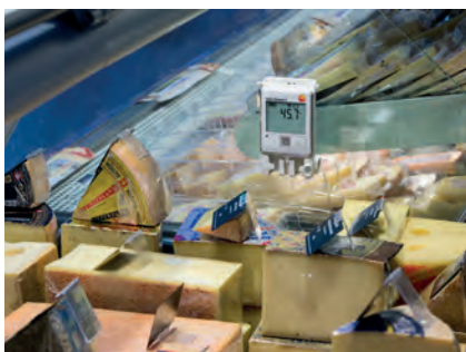
Sledování chladicího boxu v supermarketu (testo Saveris 2-T1).
