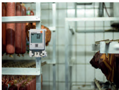
Sledování chladírny u řezníka (testo Saveris 2-T2 s externí NTC sondou a dveřním kontaktem).
