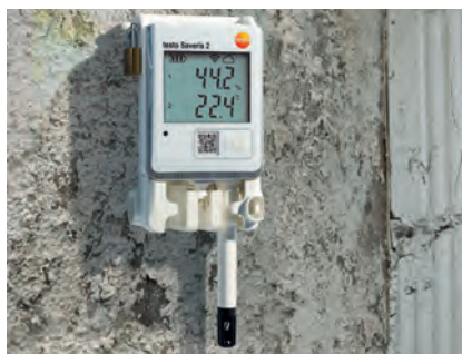
Prevence plísní - stavební vlhkost (testo Saveris 2-H2 s digitální, externí vlhkosní sondou 0572 2154).
