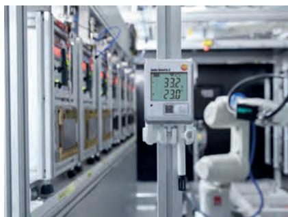
Sledování serverovny v průmyslu (testo Saveris 2-H2 s digitální externí vlhkosní sondou 0572 2154).
