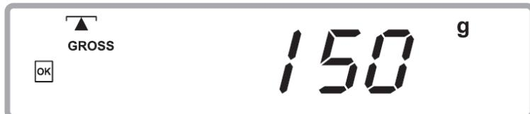
V případě, že vložená navážka bude lehčí, než je nastavený dolní limit, objeví se na displeji symbol „LO“, pokud bude vložená navážka těžší, než je nastavený horní limit, objeví se na displeji symbol „HI“.
