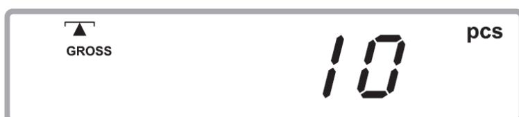
Po přidávání nebo ubírání počítaných součástek váha dále přímo ukazuje aktuální počet součástek vložený na vážicí misku (například 25ks)
