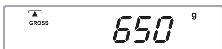
Vynulování součtové paměti se provede stiskem tlačítka **M+ Exit** a následně **UNIT Clear**
