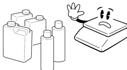
Nevystavujte váhu mechanickým rázům – mohlo by dojít k poškození tenzometrického snímače zatížení. Mějte na paměti, že váha je měřidlo a podle toho je třeba s ní zacházet.
