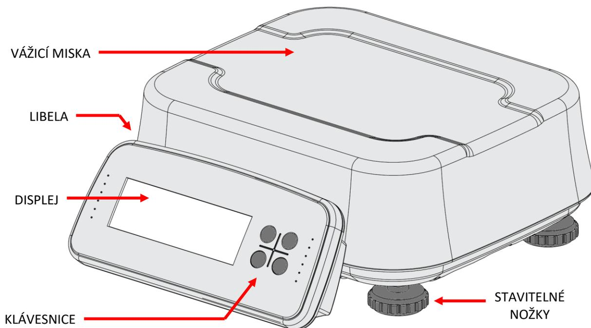
Indikátor s displejem a klávesnicí je možno po odjištění (povolení) matic naklopit do požadovaného úhlu:
