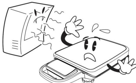
Nevystavujte váhu náhlým změnám teplot ani dlouhodobému přímému působení slunce nebo jiných zdrojů intenzivního tepelného záření. Doporučuje se zapnout váhu 15 až 30 minut před použitím pro důkladnou temperaci váhy.
