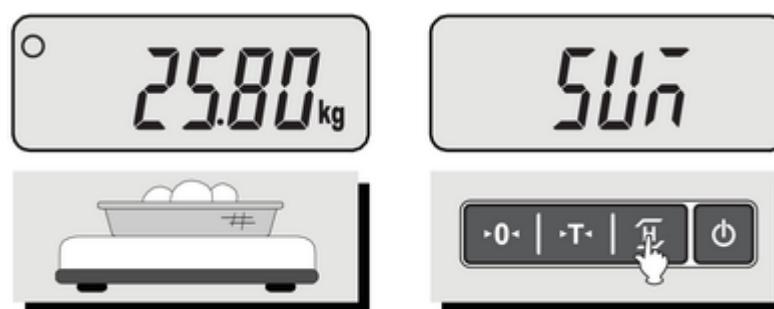
Po sejmání předchozí navážky vložte na vážicí platformu další navážku (například 19,50kg) a po ustálení opět potvrďte tlačítkem
