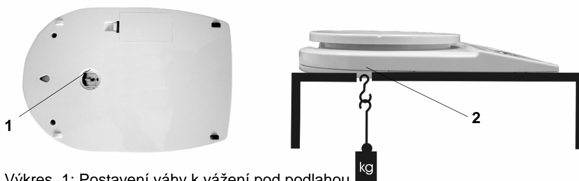
Výkres 1: Postavení váhy k vážení pod podlahou
