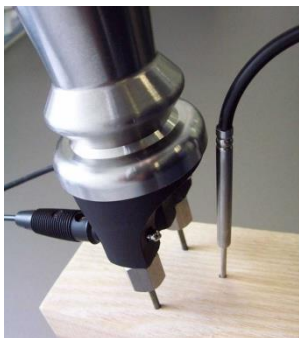
zarážecí elektroda s kladivem GHE 91 s teplotním snímačem GTF 38
