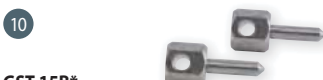
10 GST 15B* obj. č. 601281 ocelové hřeby 2 ks ocelových hřebů s otvorem, Ø 3,8 mm, délka 15 mm, pro přímé připojení k měřicímu kabelu GMK 3)
