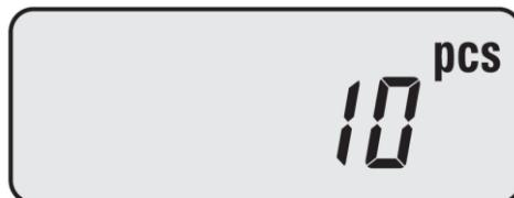
Vložte na vážící misku zvolený referenční vzorek (minimálně 10ks počítaných součástek) a potvrďte tlačítkem
